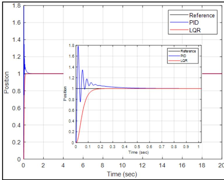
Şekil 7. İlk deney için PID ve LQR denetleyici performansının karşılaştırılması
