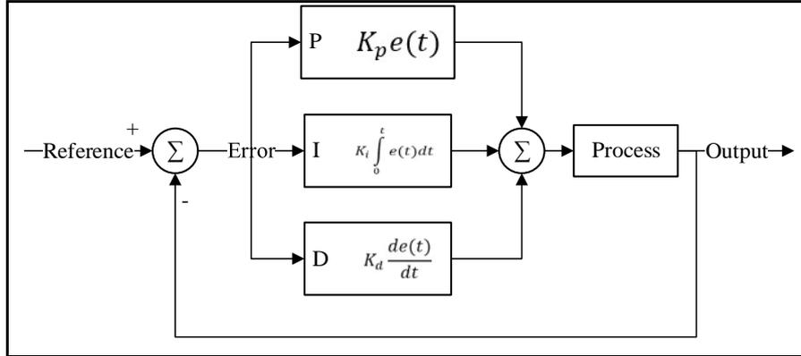
Şekil 2. PID kontrol yapısı
