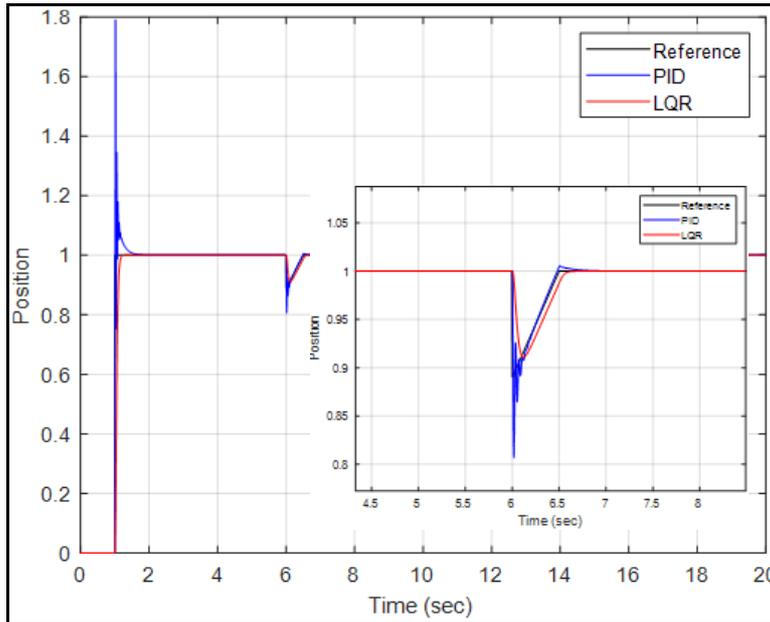
Şekil 9. Üçüncü deney için PID ve LQR denetleyici performansının karşılaştırılması
