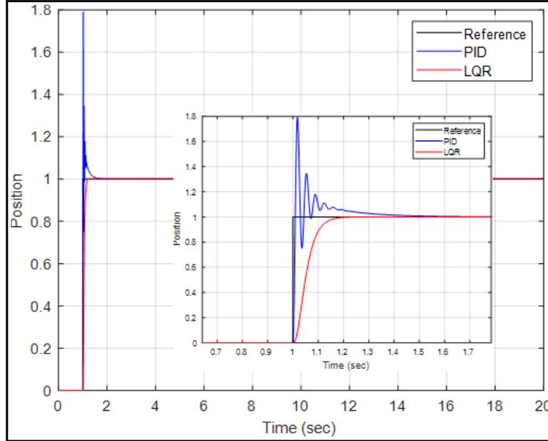
Şekil 8. İkinci deney için PID ve LQR denetleyici performansının karşılaştırılması
